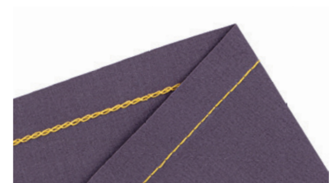
Kettenstich Verbindungs- und Ziernaht
